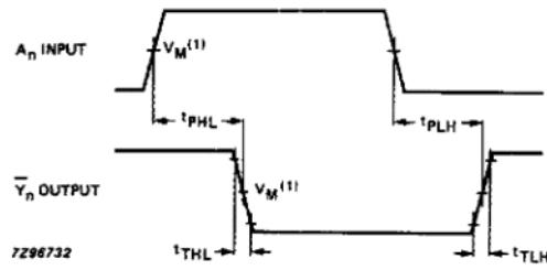
(1) HC :  $V_M = 50\%$ ;  $V_I = \text{GND to } V_{CC}$ .
